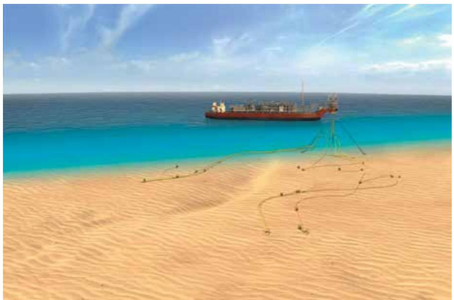
Maquette de la FPSO connectée à un réseau de conduites et d'infrastructure sous-marines.
