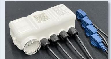
Fin fan vibration measurement
